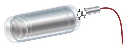
応答速度 静電容量方式: ~ 5 kHz 光ファイバー方式: ~ 3 MHz
