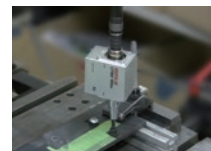
ナットランナの出力軸とソケットの間に入れるだけで簡単にトルクチェック
